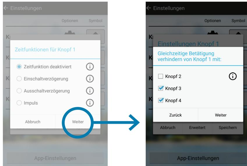
Wenn Sie eine Verriegelung zwischen zwei oder mehr Tasten einstellen, wird verhindert, dass die Ausgänge gleichzeitig aktiv sind.
